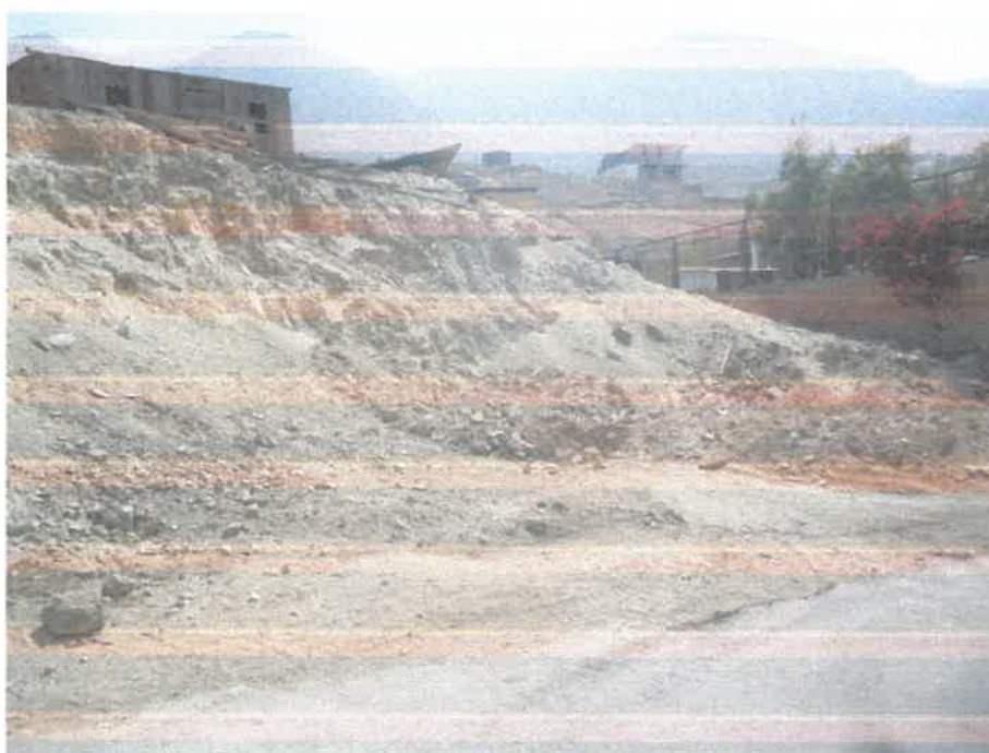
FOTOGRAFÍA N° 44: Vista de un corte existente al interior de un predio urbano, cerca de la calicata C-2. Nótese que el Conglomerado de origen sedimentario ha sido intruído por Gabrodiorita de origen volcánico intrusivo.
